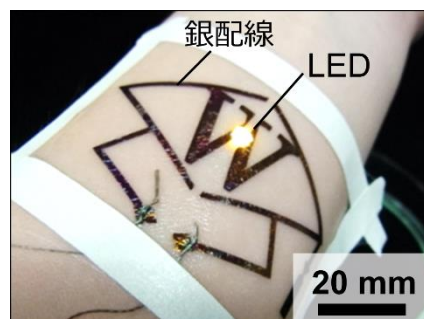
図3 SBS ナノシート上にLED点灯回路を実装し腕に貼付した様子。皮膚上でも配線とLEDの電気的接続は安定であった。白いテープ枠はナノシートの貼付に用いたフレーム。
